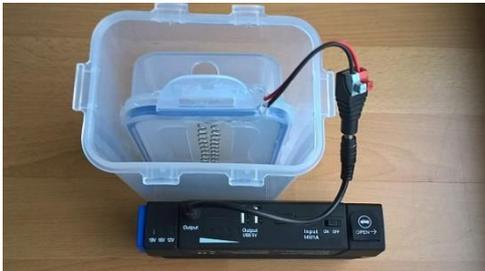
In der inneren Anodenkammer des Elektrolysegerätes entsteht das ionisierte, saure [Anolyt](#), in dem Chlordioxid übrigbleibt, wenn die weiteren darin gebildeten oxidativen Gase Sauerstoff, Wasserstoffperoxid und Ozon nach kurzer Zeit in die Umgebungsluft ausgasen sind. **Weil dieses Chlordioxid aus Anolyt entsteht, wird es auch A-CDL genannt.**
