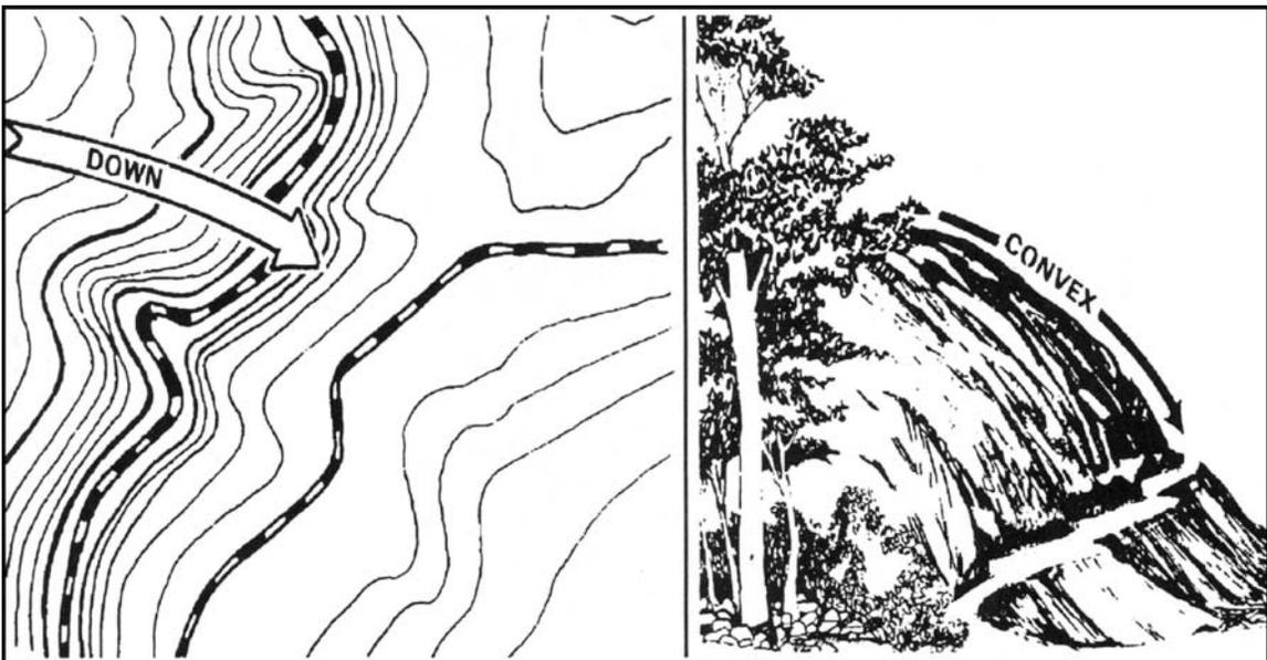
**Figure 10-9. Convex slope.**
